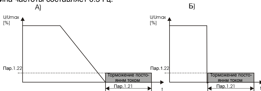
Рис. 7.4 Торможение с помощью постоянного тока.
