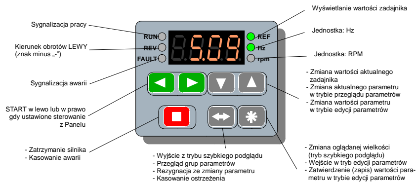
Rys. 3.1. Panel sterujący, podstawowe funkcje przycisków i wyświetlacza
